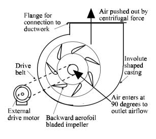
Figure 4.4 Centrifugal fan
