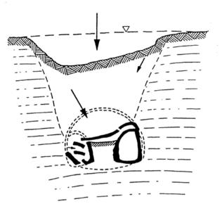
Fig. 7. Krieberg tunnel collapse [5]
