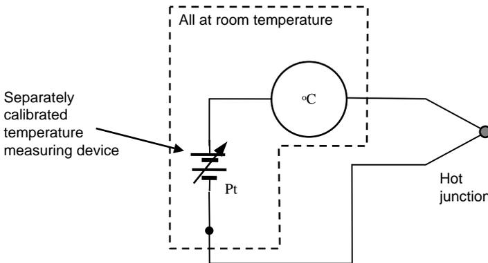
**(a) Thermocouple calibration**
